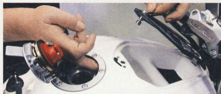
Nejdřív odemknete víčko nádrže a pak tlačítkem odjistíte schránku na doklady
