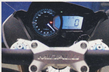
Přístroje umějí změnit barvu. V otáčkoměru se schovávají písmenka FGR.
